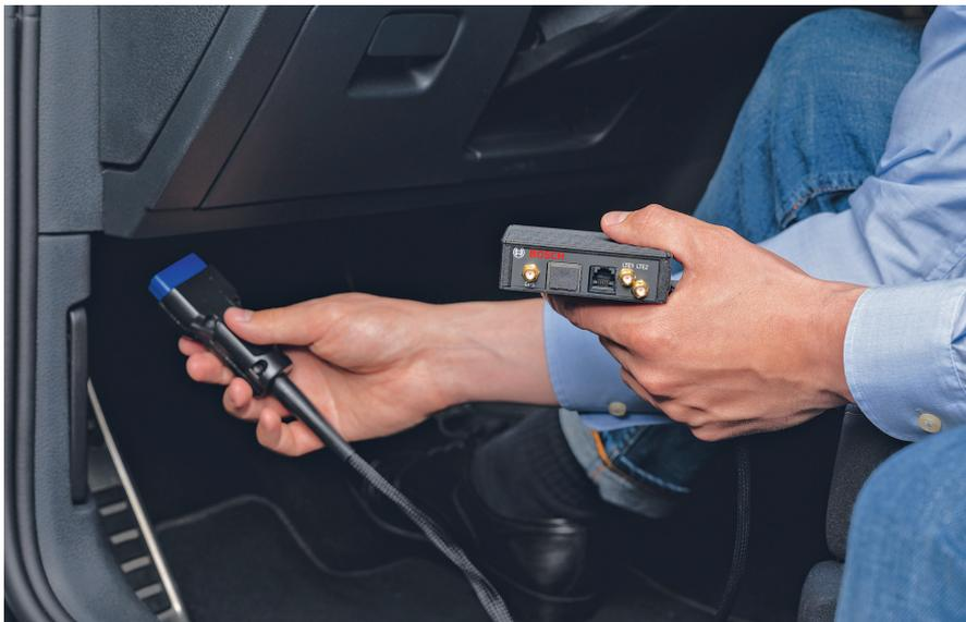
**Bild 2: Plug-and-Play Installation der digitalen Lösung Remote Vehicle Access**
